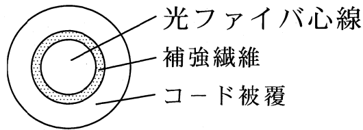
図1 単心光コード構造断面図
