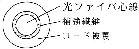
図1 単心光コード構造断面図
