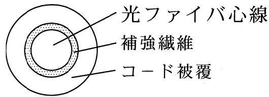
図1 単心光コード構造断面図
